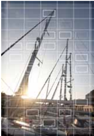
Messbereich bei der Mehrfeld- oder Matrixmessmethode.
